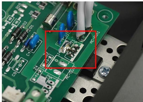
各部品を固定した状態で、トライアックをはんだ付けします。
