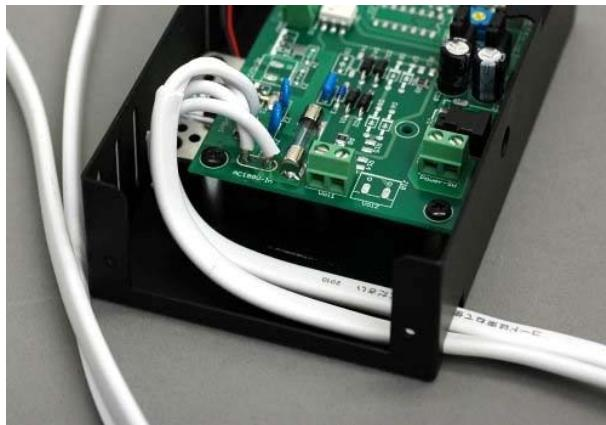
図のようにケーブルを引き回します。
