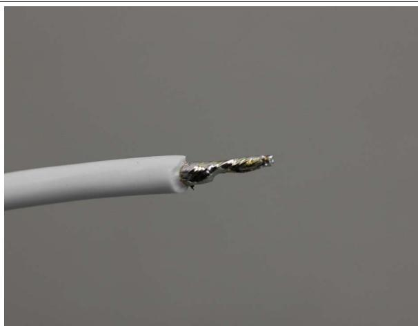
両方の線端に、はんだを流し込んだら、基板ケースの穴に電源ケーブル（延長ケーブルを切斷したもの）を通します。
