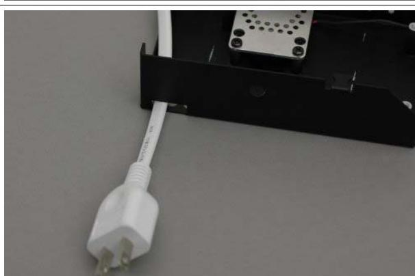
基板ケースに通したうえで、先端を AC100V-In のスルーホールに差し込みます。
