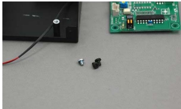
トライアックが固定できたら、基板ケースから基板を外します。
