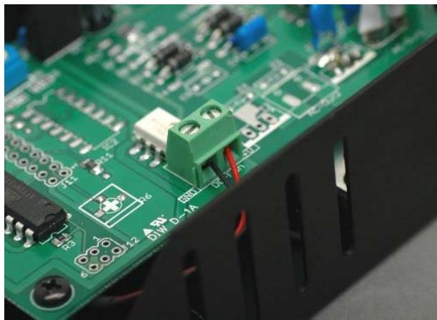
最後に DC-Fan(J5)の端子台に、ファンモーターから出ているケーブルを取り付けます。
