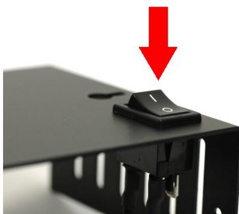
基板ケースの上部品へ電源スイッチを取り付けます。
