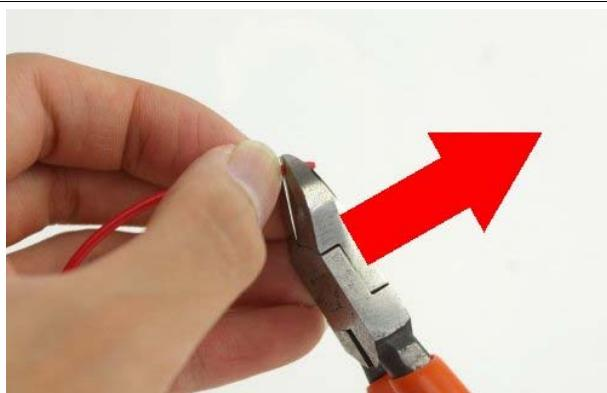
中の金属線が見える程度まで切り込んだら、被覆を外側に引っ張り、被覆をむきます。
