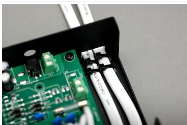
電源ケーブルの位置が決まったら 4 本の結束ケーブルを取り付け、きつく締めます。
