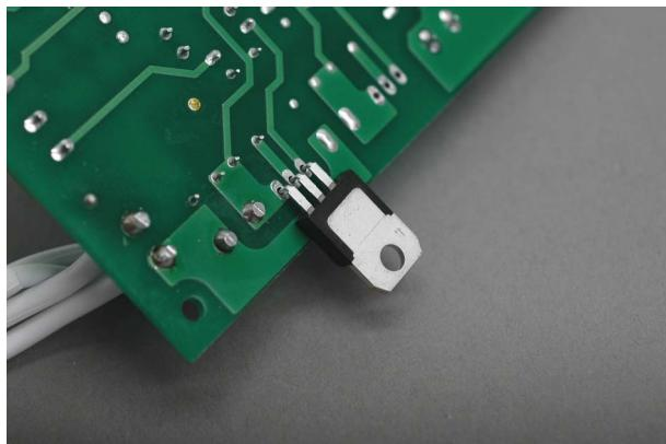
足を曲げたトライアックを、図のように挿し込みます。
