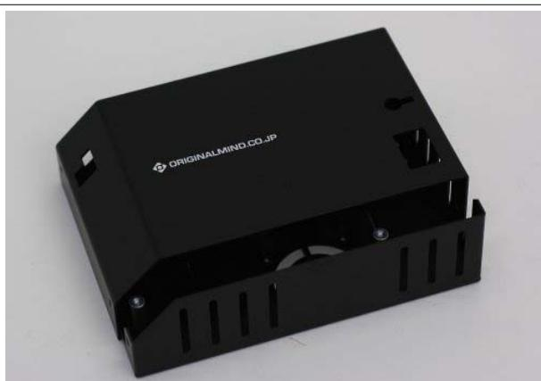
基板ケース側面のネジを外し、基板ケースを上下に分割します。
