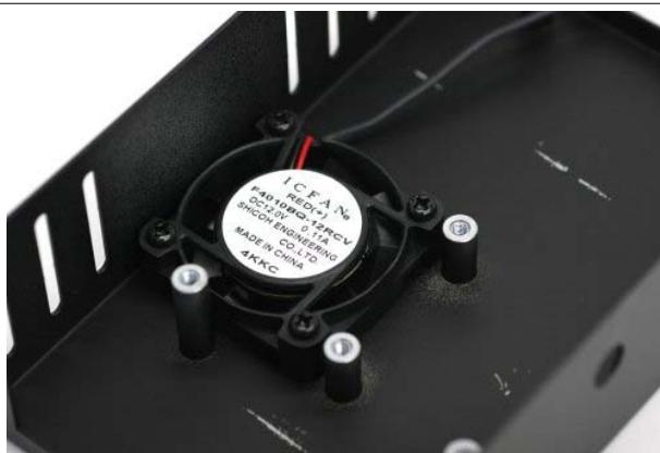
基板ケース下の部品に、なべネジ（黒）M3×9（ロットによってM3×12）を4本使用して、DC ファンモーターを取り付けます。
