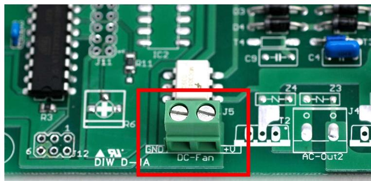
トライアックを冷却するための、ファンモーターを取り付ける端子です。
