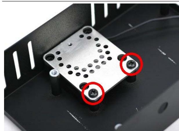
DC ファンモーターの上から放熱板をのせ、バインドネジ（黒）M3×5 を 2 本使い、固定します。
