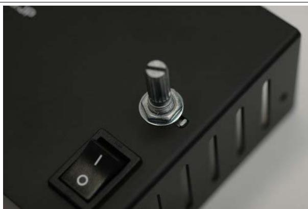
突起が外れないようにおさえながら、ワッシャーとナットを取り付け、固定します。
