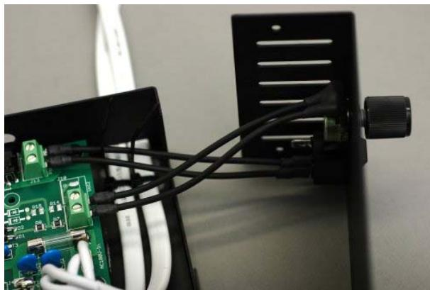
同じように、Vol1(J9)の端子台にボリュームを取り付けます。
