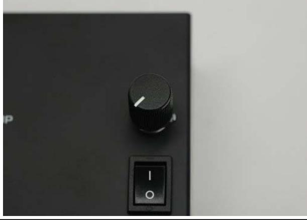
最後にボリュームを取り付けて基板ケース上の組み立ては完了です。
