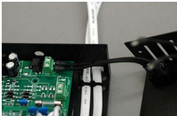
Power-SW(J13)の端子台に電源スイッチから伸びているケーブルを取り付けます。
