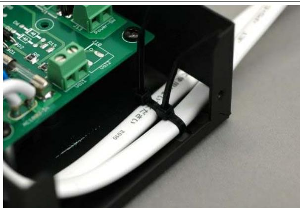
ある程度ケーブルの引き回しが決まったところで、結束バンドで電源ケーブルを軽く固定します。
