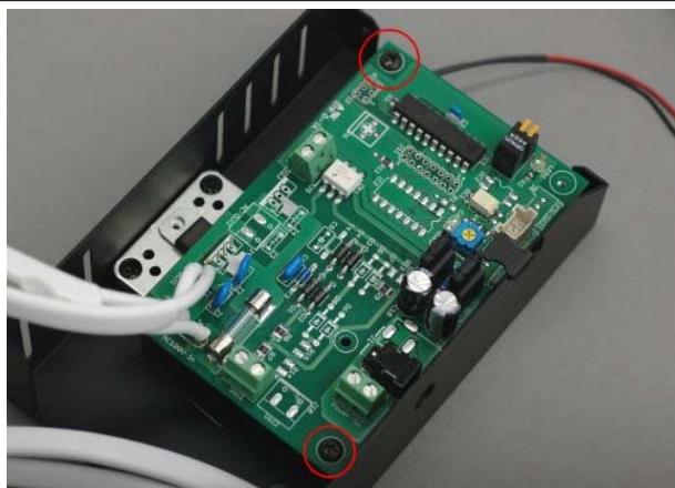
トライアックが抜けないよう、抑えたまま基板ケースに収納します。
