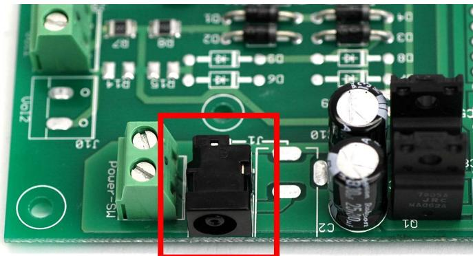
電源用の AC アダプターを接続します。
