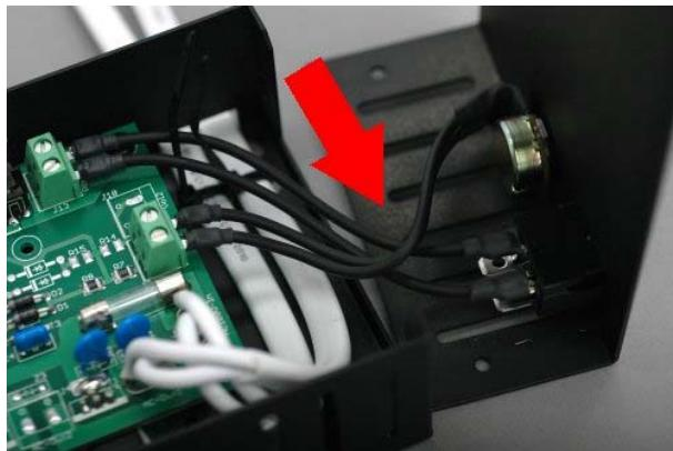
引き回しのため、ケーブルを図の方向に折り曲げ、癖を付けます。
