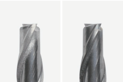
加工後のエンドミルの摩耗度比較 左：クーラント供給なし 右：クーラント供給あり
