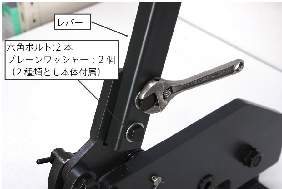
METAL SHEAR 本体付属のねじでレバーを取り付けます。
