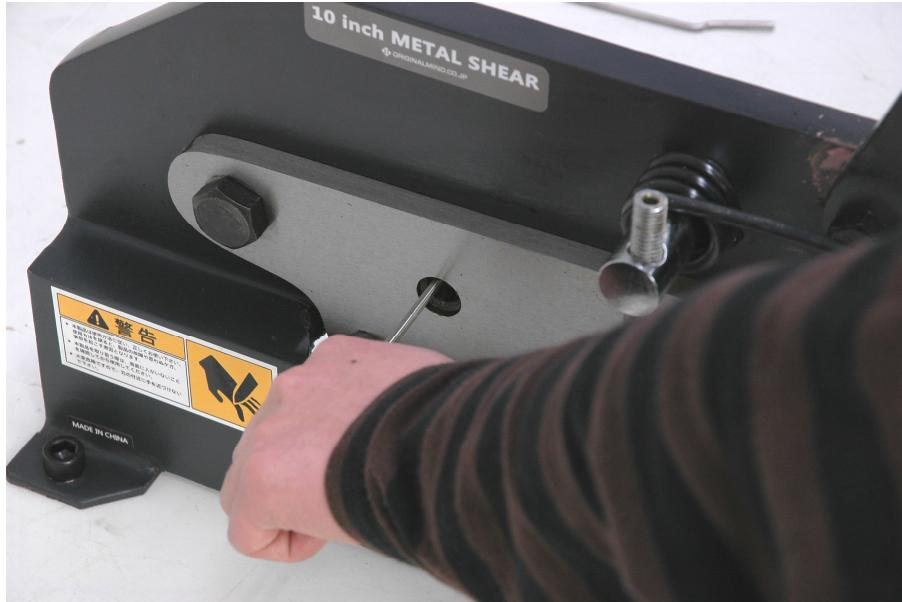
①棒材をブレードの棒材切断穴に挿し込みます。
