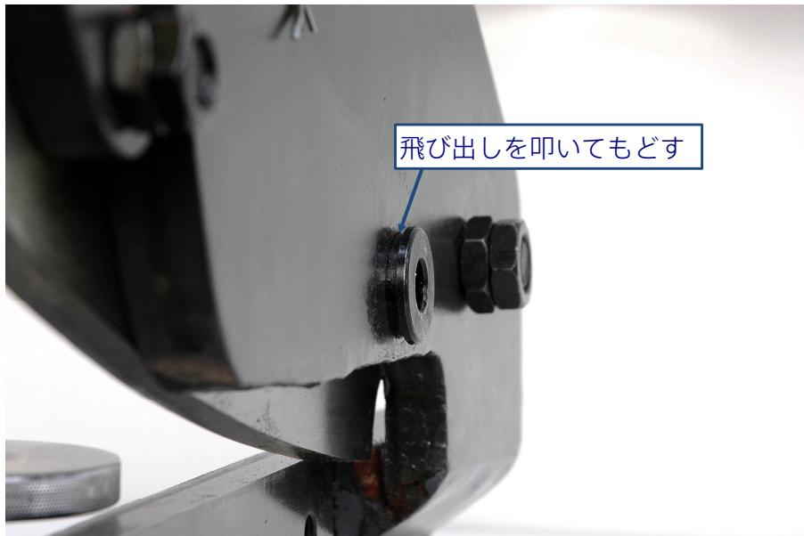
直径の小さい棒材を切断すると、棒材切断穴の部品が飛び出すことがあります。部品が飛び出したときはプラハンマーなどで叩いて奥まで押しこんでください。
