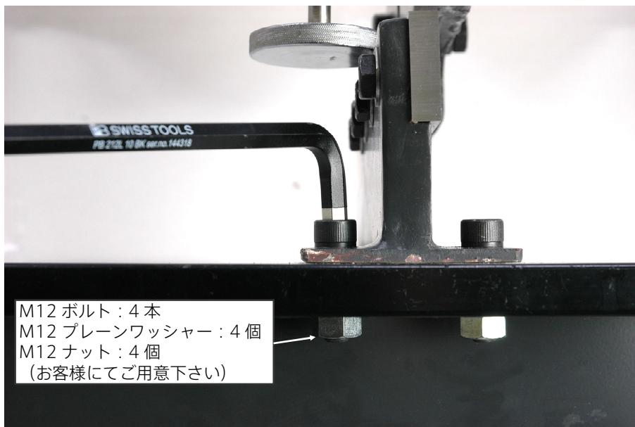
図のように本製品を作業台に固定します。
