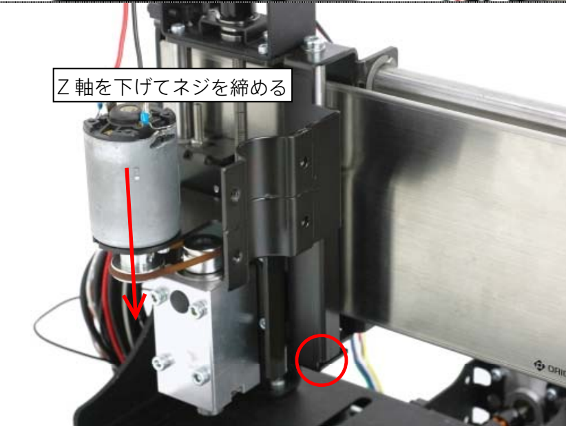
Z軸を上げてネジを締める
