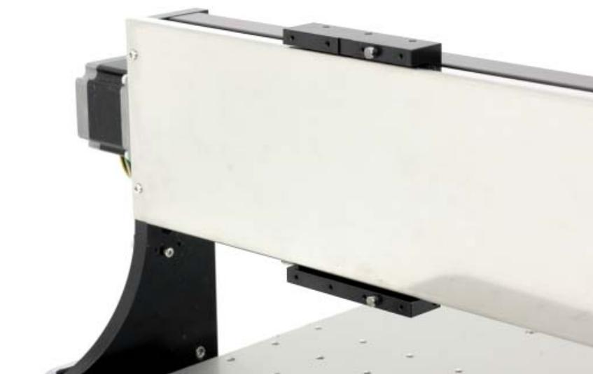
スピンドルベース、X軸カバー（上）、Z軸カバー、Z軸モータ取付板、Z軸ベースを取り外します。COBRA本体の組立マニュアルを確認しながら取り外してください。
