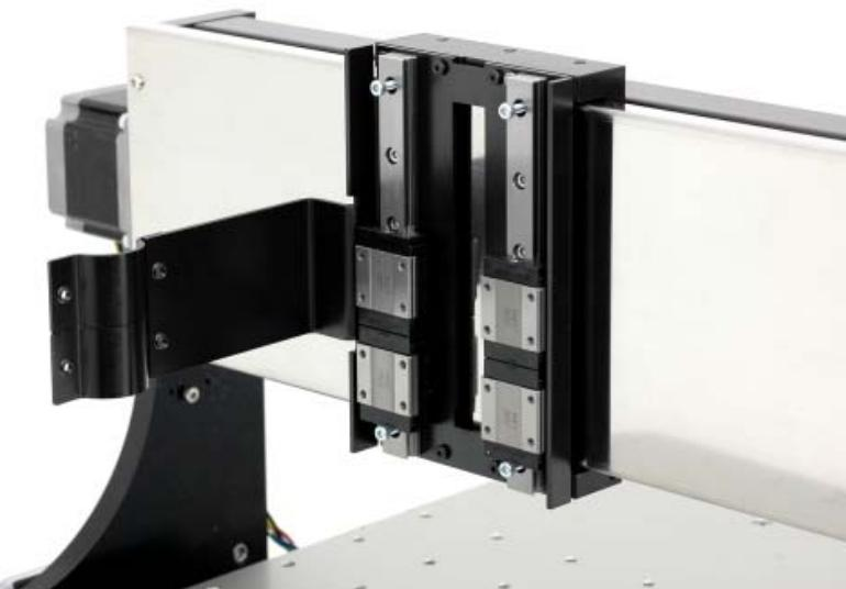
クーラントライナーマウント (COBRA 用) を X 軸テーブルに取り付けます。低頭ボルト M3×10 を 8 本使用します。
