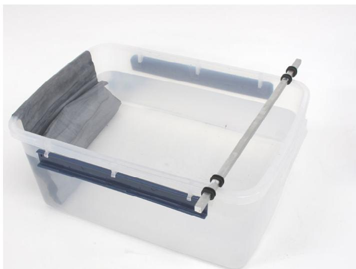
電解液 8L を投入します。アルミ棒は使用時に図のように設置するので、アルミ棒に付いているストッパーの位置を調整しておきます。
