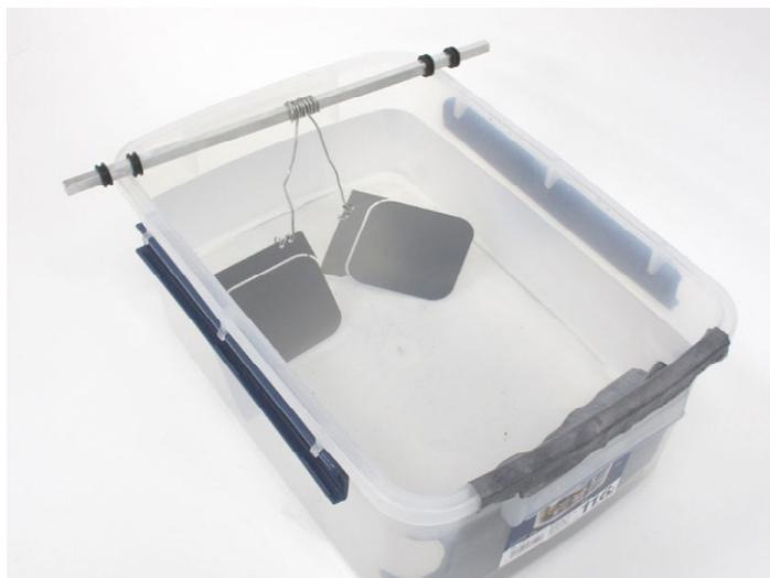
陽極酸化槽のうえにアルミ棒を設置します。アルミ材が鉛板に接触するとショートしてしまうのでできるだけ離して設置します。
