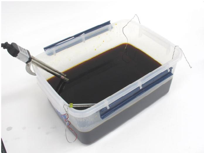
染色槽の中にアルミ材を投入します。液温が 60°C 以上になると染まりが悪くなるのでヒーターの電源を切ります。液温は 50±5°C を維持します。この状態で 30 分置いておきます。気泡や温度差が生じることがあるので時々アルミ材をゆすったりひっくり返したりします。
