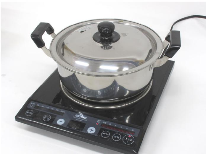
その間に次の工程で使う封孔槽を温めておきます。封孔処理は 90° 以上で煮て処理します。酸性の臭気が発生するので換気を行なってください。
