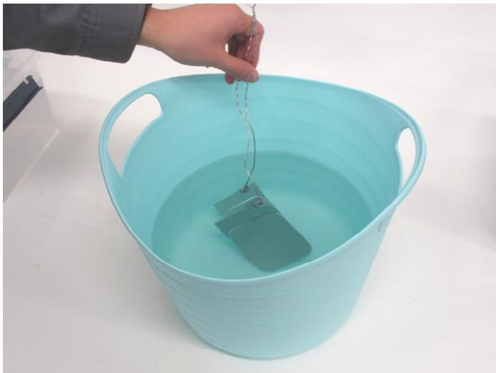
アルミ棒からアルミ線をはずし、洗浄槽にて電解液を落とします。陽極酸化皮膜の保護のため、この工程は 10 秒程度ですばやく行なってください。
