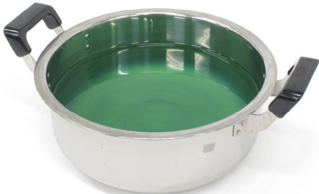
鍋のサイズにあわせて水と相応量の封孔剤を入れます。封孔剤の容器 1 本で水 18L 分となります。鍋はホーロー製を推奨しますが、ステンレス製でも代用できます。
