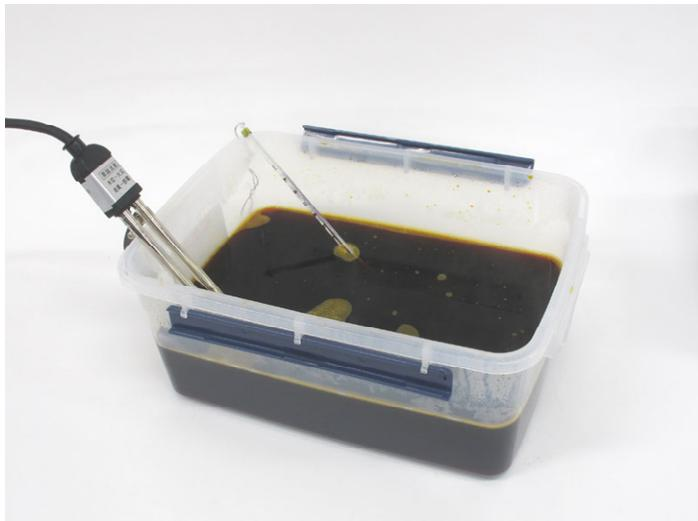
染色槽に投げ込みヒーター、温度計を入れ、投げ込みヒーターのコンセントをつなぎます。染色工程は染料の温度が  $50^{\circ}\text{C} \pm 5^{\circ}\text{C}$  の状態で行います。冬場は液温  $55^{\circ}\text{C}$  に上昇するまで 1 時間近くかかることがあります。染料が劣化しますので、絶対に沸騰させないでください。
