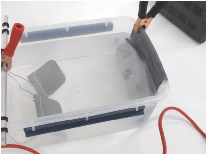
陽極酸化処理の最中は写真のように鉛板から気泡が発生します。電解液が霧になって飛散するので、新聞紙等をかけておきます。
