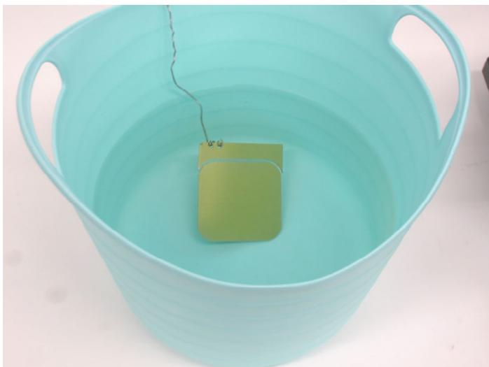
洗浄槽にて染料を落とします。陽極酸化皮膜の保護のため、この工程は 10 秒程度ですばやく行なってください。
