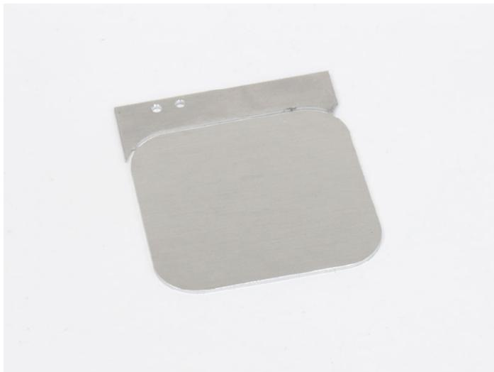
アルマイトを行うアルミ材を洗浄します。皮脂などの油汚れが残っていると着色時に色むらになってしまいます。中性洗剤やマジックリンなどの洗剤で念入りに洗浄します。洗浄後は素手でアルミ材に触らないようにします。
