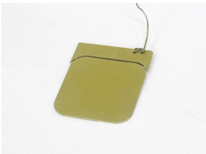
洗浄槽にて封孔液を落として完成です。
