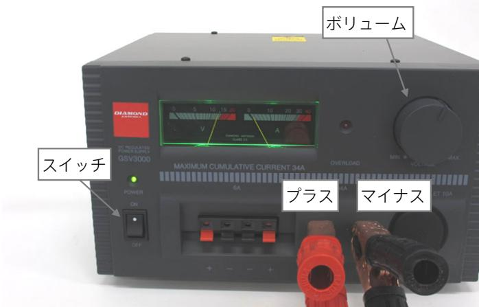
電源装置にブースターケーブルを接続し、電源装置のスイッチを入れます。ボリュームをひねって電圧が12Vになるように調整します。
